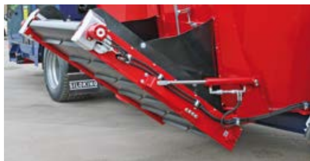
Откидной разгрузочный транспортер может работать в различных позициях и подает корм даже в высокие кормушки.
