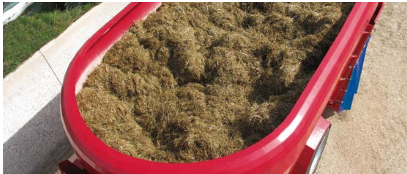
Коническая форма бункера, Flow-Plus-ограничительное кольцо бункера и небольшой вес определяют концепцию машин Duo Avant.
